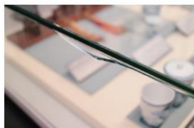
ケース破損部
