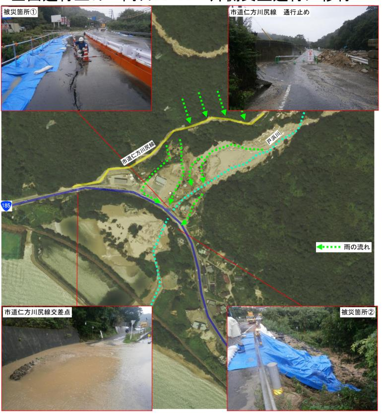
7月に被災した2箇所は、大形土のうで応急復旧しておりますが、 アスファルト舗装や路盤(土のう上部)にひび割れが発生しており、 9月9日6時50分に通行止めになり、雨水の対策及び復旧を進め、 9月9日18時に片側交互通行に移行しました。
