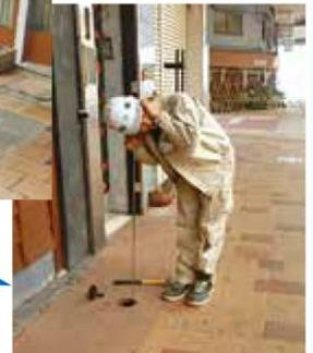
音聴棒を使った漏水調査
