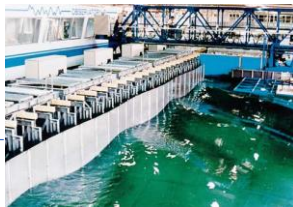
(実験施設検討例) 平面水槽用多方向造波装置
