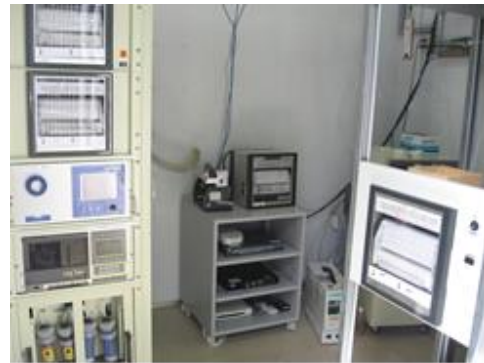
大気測定局内の自動測定機
