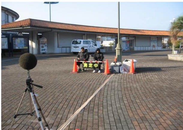
24時間自動車騒音・振動測定（国道31号）の様子
