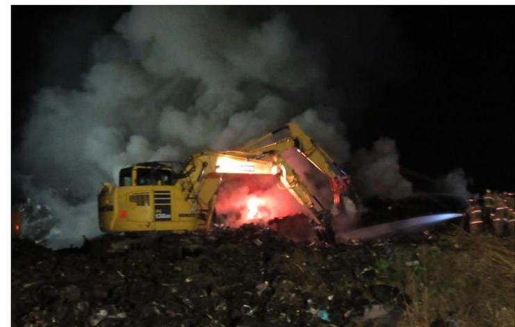
※ 消防局による消火活動に協力するため、重機により応急的な防火帯(燃焼物を切り離し延焼阻止するもの)を設けるとともに、切り離れた燃焼中のごみを重機で崩し広げ、早期完全消火のための援助に当たりました。
