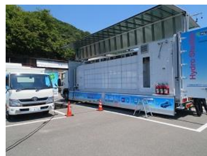
移動式水素ステーション
