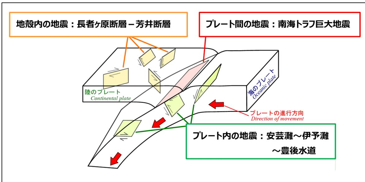
図3-4 地震発生のメカニズムと地震のタイプ
