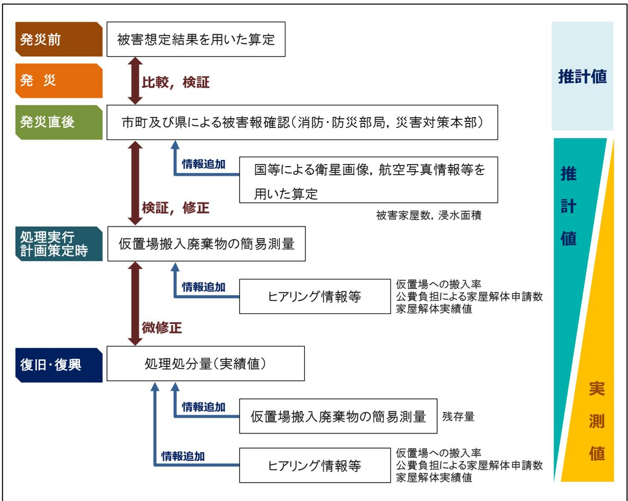
図 3-7 災害廃棄物発生量の算定方法の変化
