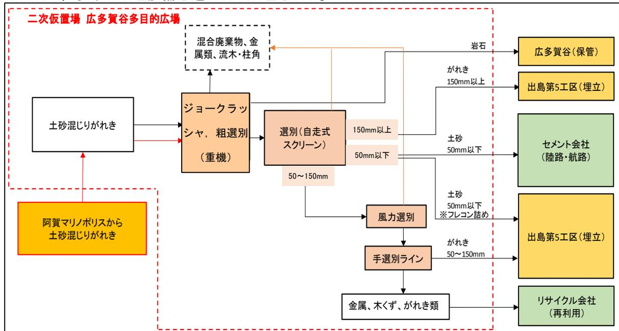
土砂混じりがれきの処理フロー（詳細）
