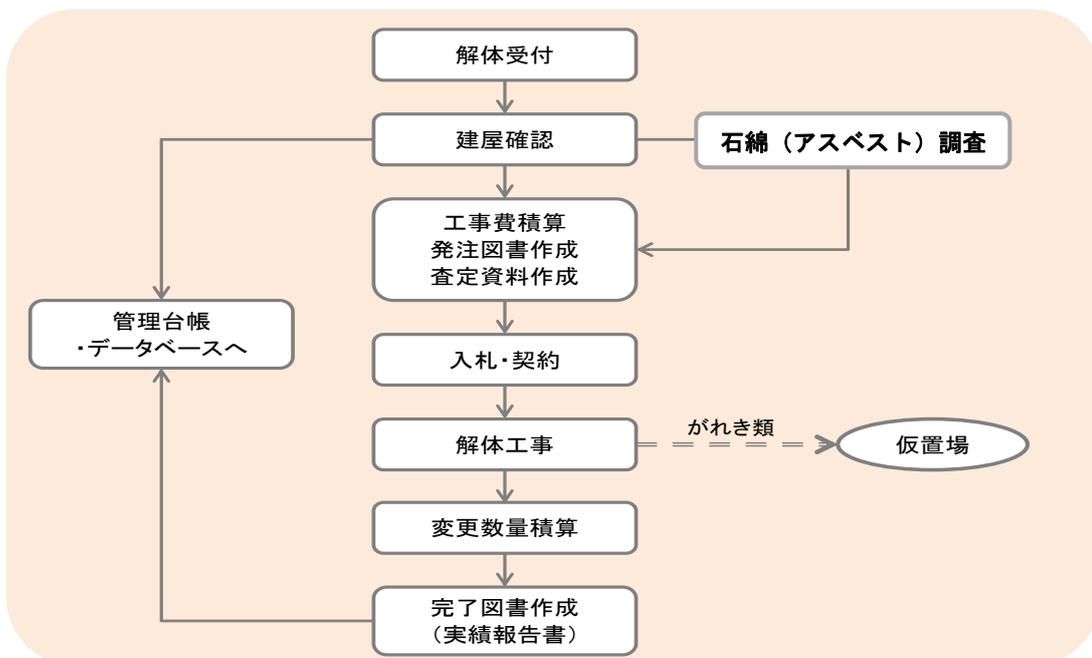
図3-14 損壊家屋等の解体・撤去の流れ（例）
