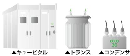
平成2年頃までに国内で製造された電気機器は、低濃度PCBの可能性ががあります。
