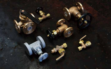
坂本機械工業が修理を担っている部品の一例を見せてもらった。これは、船の配管につながっているバルブ。JMUを中心に、造船に関わるさまざまな会社から部品を預かり、職人を通じて加工や修理を行うのが彼らの仕事だ。
