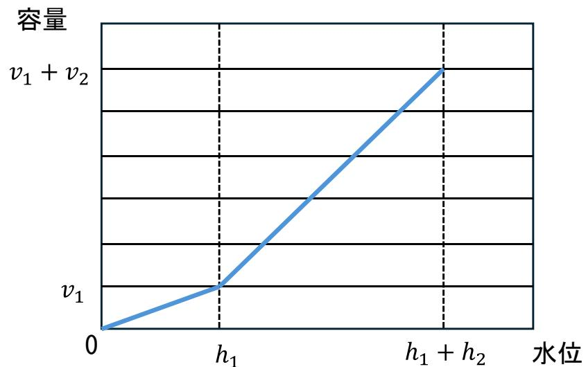
図3-9-2 調整池の水位容量曲線のイメージ
