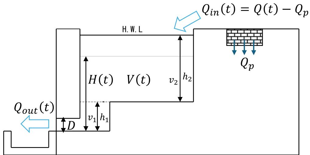
図3-9-1 調整池規模算定の模式図
