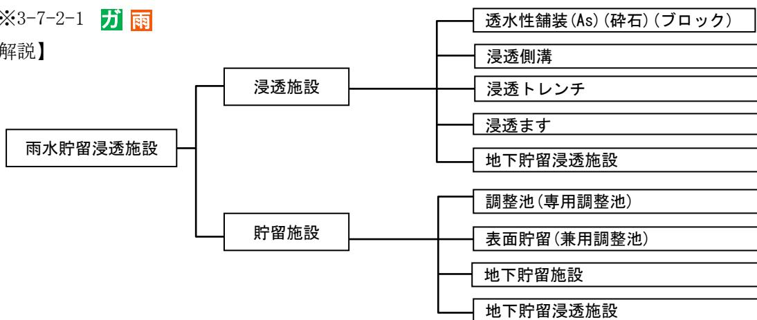
図3-7-2 主な浸透施設と貯留施設
