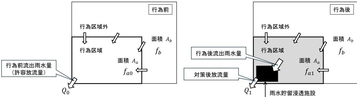
$$Q_0 \text{ 「行為前の流出雨水量の最大値」} \geq Q_1 \text{ 「対策後放流量の最大値」}$$
