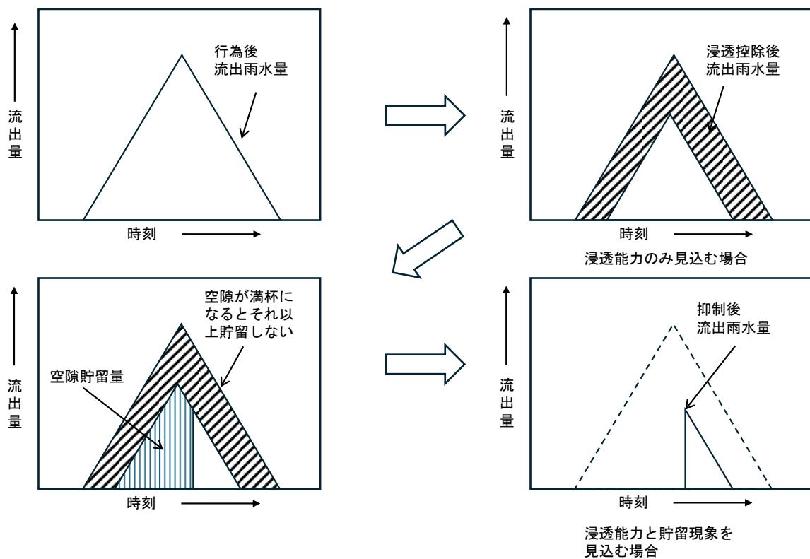
図3-8-1 浸透施設の流出抑制効果の概念図
