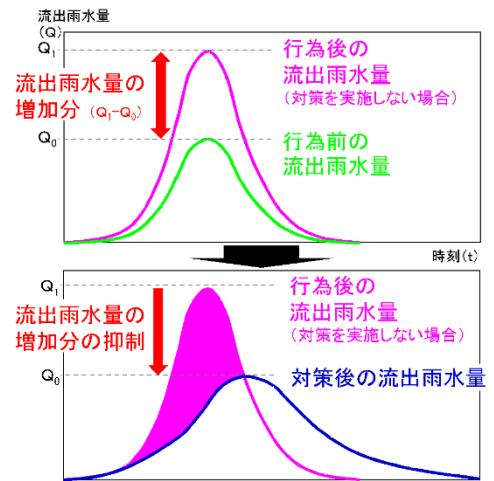
図 2-7-3 流出雨水量の增加分の抑制
