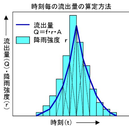
図3-6-1 時間毎の流出量の算定方法
