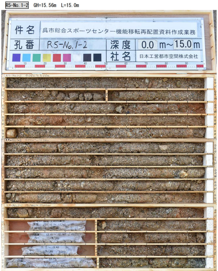
図 3.24 R5-No.1-2 ボーリング結果
