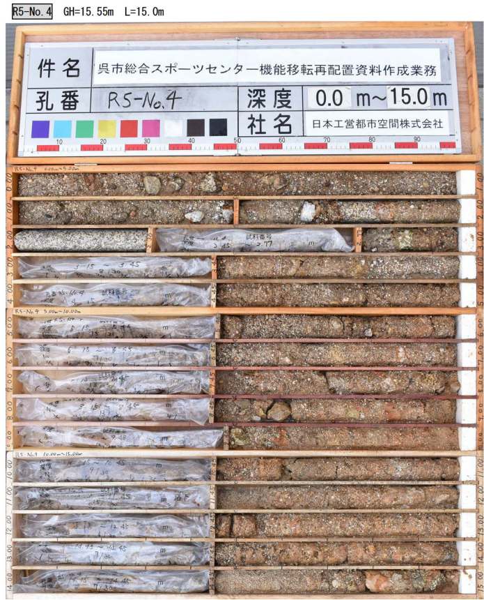
図 3.27 R5-No.4 ボーリング結果
