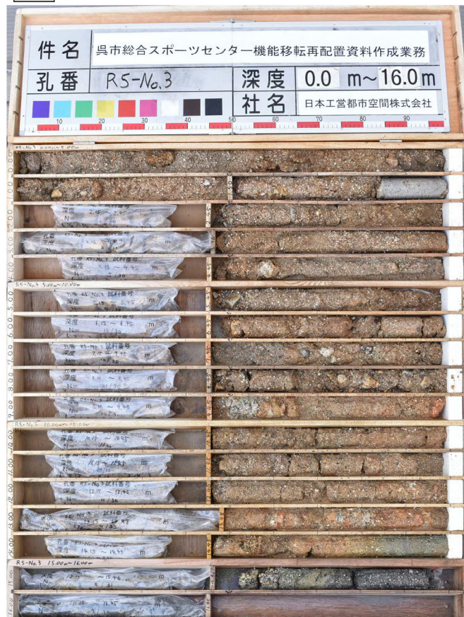
図 3.26 R5-No.3 ボーリング結果
