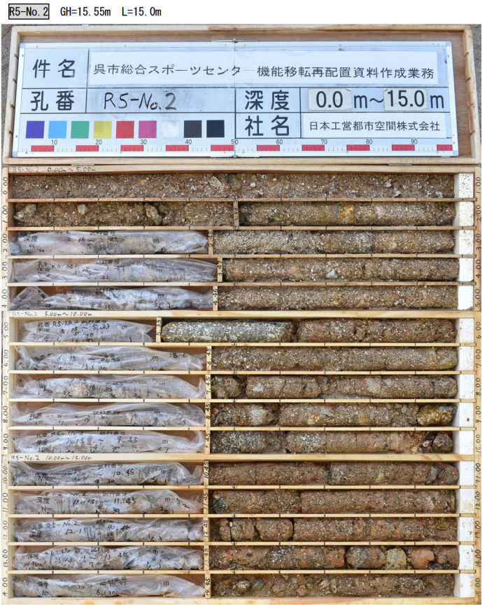
図 3.25 R5-No.2 ボーリング結果
