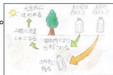
図2 生分解性プラスチックのメカニズム
