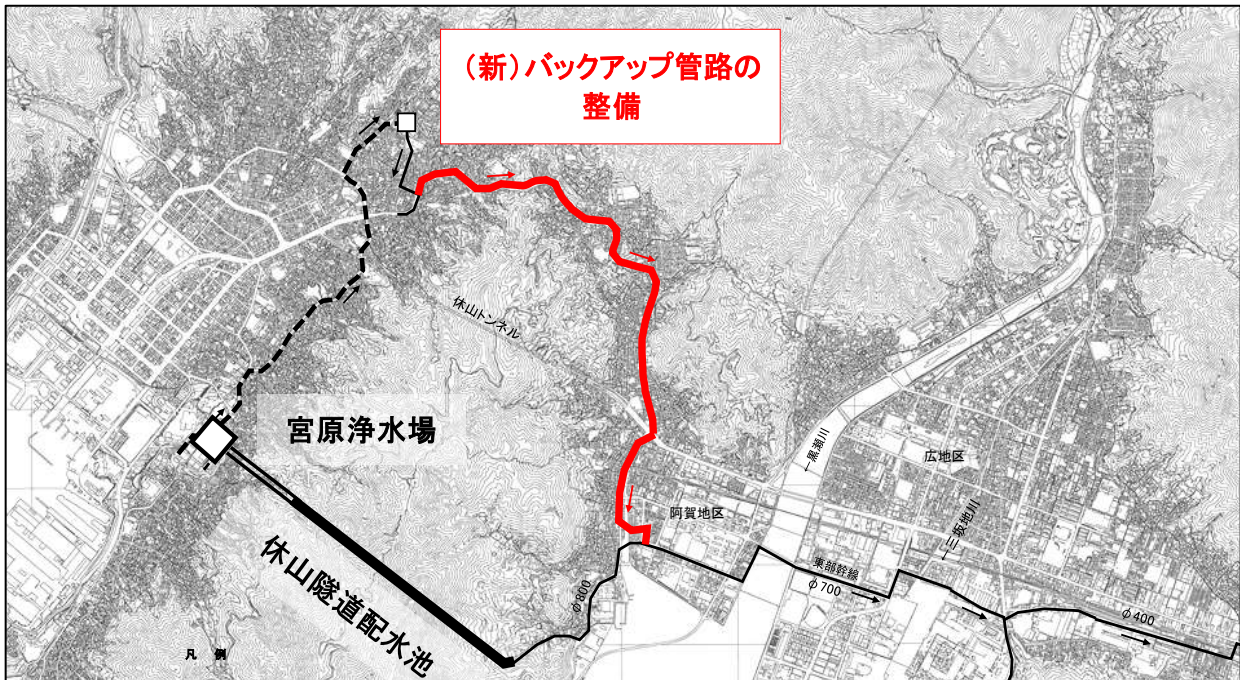
基幹配水池バックアップ管路図
