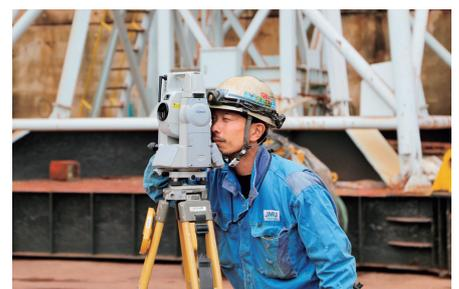
▲3D精度計測の様子 図面通りの位置で組み立てられているか、ミリ単位で確認する
