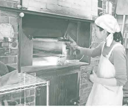
手づくりの石窯は、体験ワークショップなどを開いて3カ月をかけて完成させた。炉室は約2.3帖の広さで一度におよそ30個のパンを焼くことができる。
