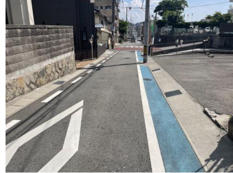
カラー舗装による空間確保
