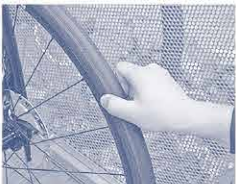
空気圧や金属片が刺さっていないか、タイヤの点検は必須
