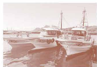
洋平さんが建造に携わったイワシやちりめんを獲る船。2艘の船で網を引くパッチ網漁で、網を引網船(写真右、中央)と獲れた魚を港まで運ぶ運搬船(写真左)。用途によって船型も船速も異なる。
