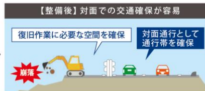
【4車線】 工事規制影響の最小化が可能(上下別に開放可能)
