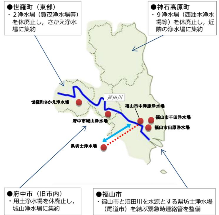
〔凡例〕 ● 主な浄水場    ≡ 水道用水供給事業の管路    ..... 送水トンネル・海底管・緊急時連絡管    → 市町をまたぐ主な送水方向
