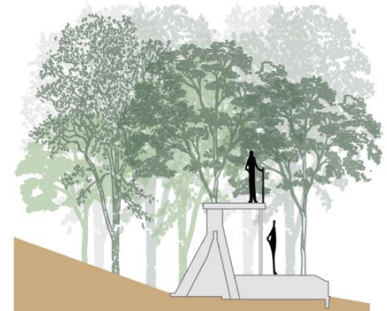
▲砂防えん堤を見晴台として活用
