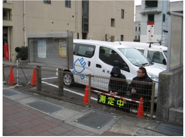
24時間自動車騒音・振動測定（国道185号）の様子
