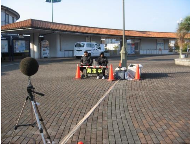
24時間自動車騒音・振動測定（国道31号）の様子
