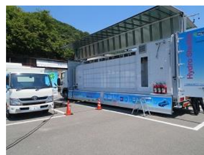
移動式水素ステーション
