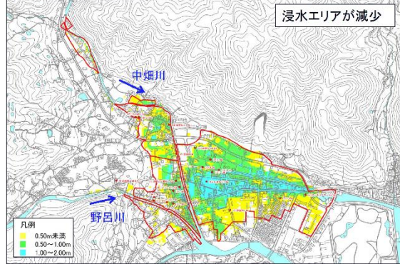
図-6 (c) 安浦駅付近の溢水・越水のシミュレーションによる7月7日8:00~11:00の状況
