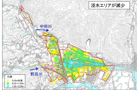
図-6 (c) 安浦駅付近の溢水・越水のシミュレーションによる7月7日8:00~11:00の状況
