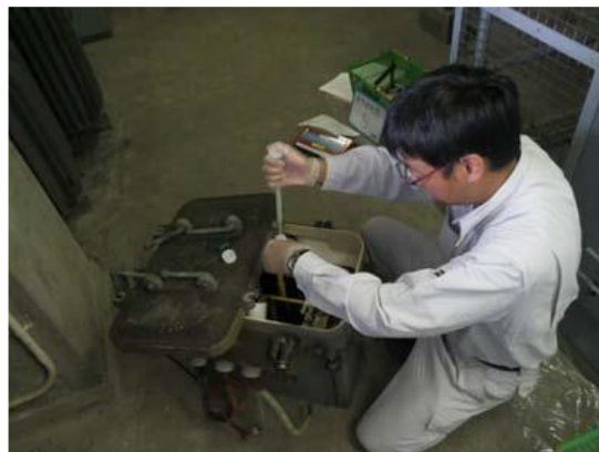
PCB 絶縁油濃度分析試料採取状況
