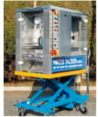
非常用給水パック製造機 (1リットルの水をパック詰めし、配布することができます)
