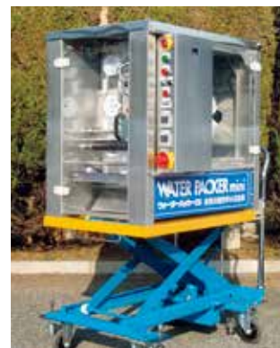
非常用給水パック製造機 (1リットルの水をパック詰めし、配布することができます)
